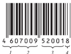
Рис 7. Расшифровка штрихкода EAN-13:
